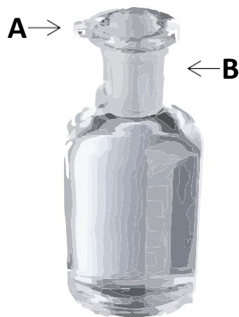
Figura 4.2. Frascos para ácidos. A, marca de vidrio en el tapón y B, marcas de vidrio en el cuello de la botella.
